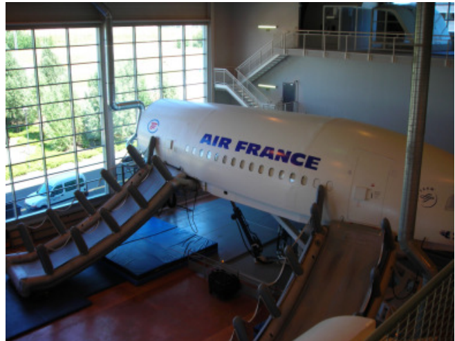
Simulateur sur vérins hydrauliques et toboggans
